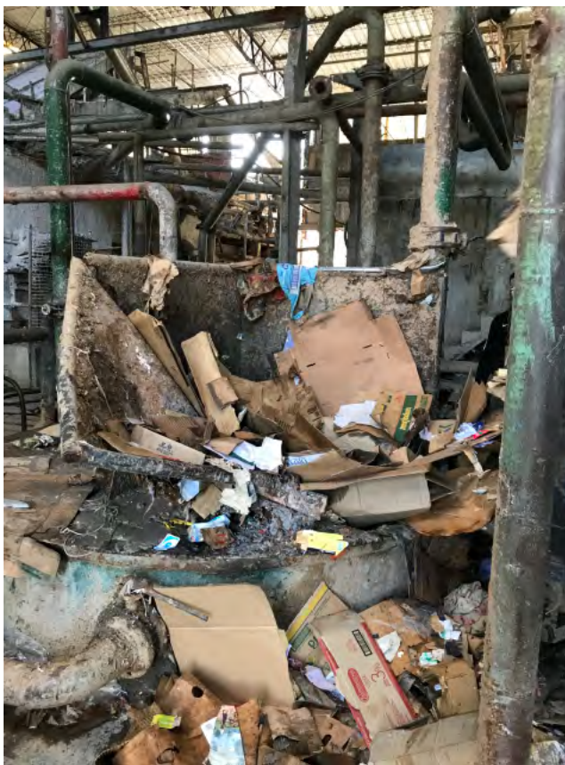
Ilustración 5: Pulper cargado con insumos y cartón para fabricar papel Kraft. Fotografía propia.
