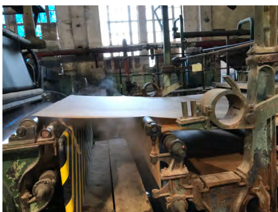
Imagen 13: Lugar de transferencia del sector prensado al de secado. Fotografía propia.
