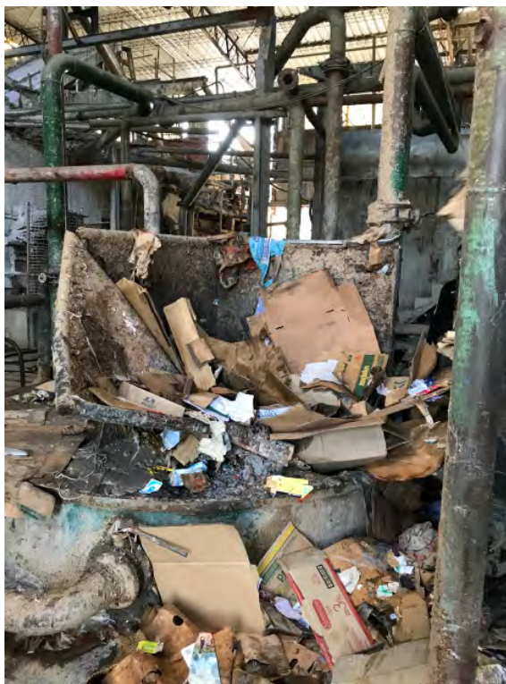
Imagen 9: Pulper cargado con insumos y cartón para fabricar papel Kraft. Fotografía propia.
