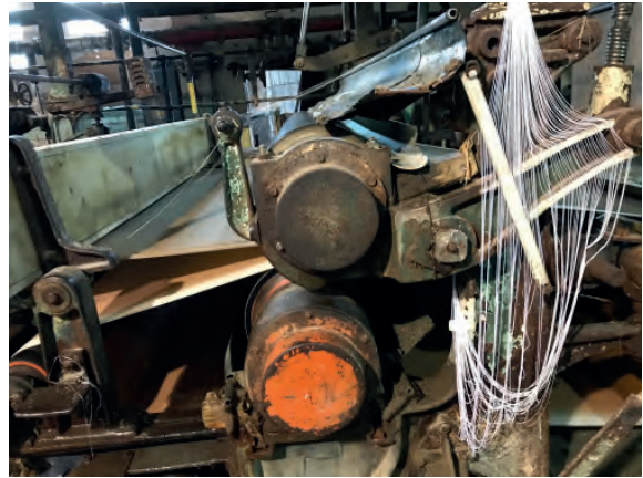
Imagen 16: puesto del 3er. ayudante, con piolines que guían la pasta. Fotografía propia
