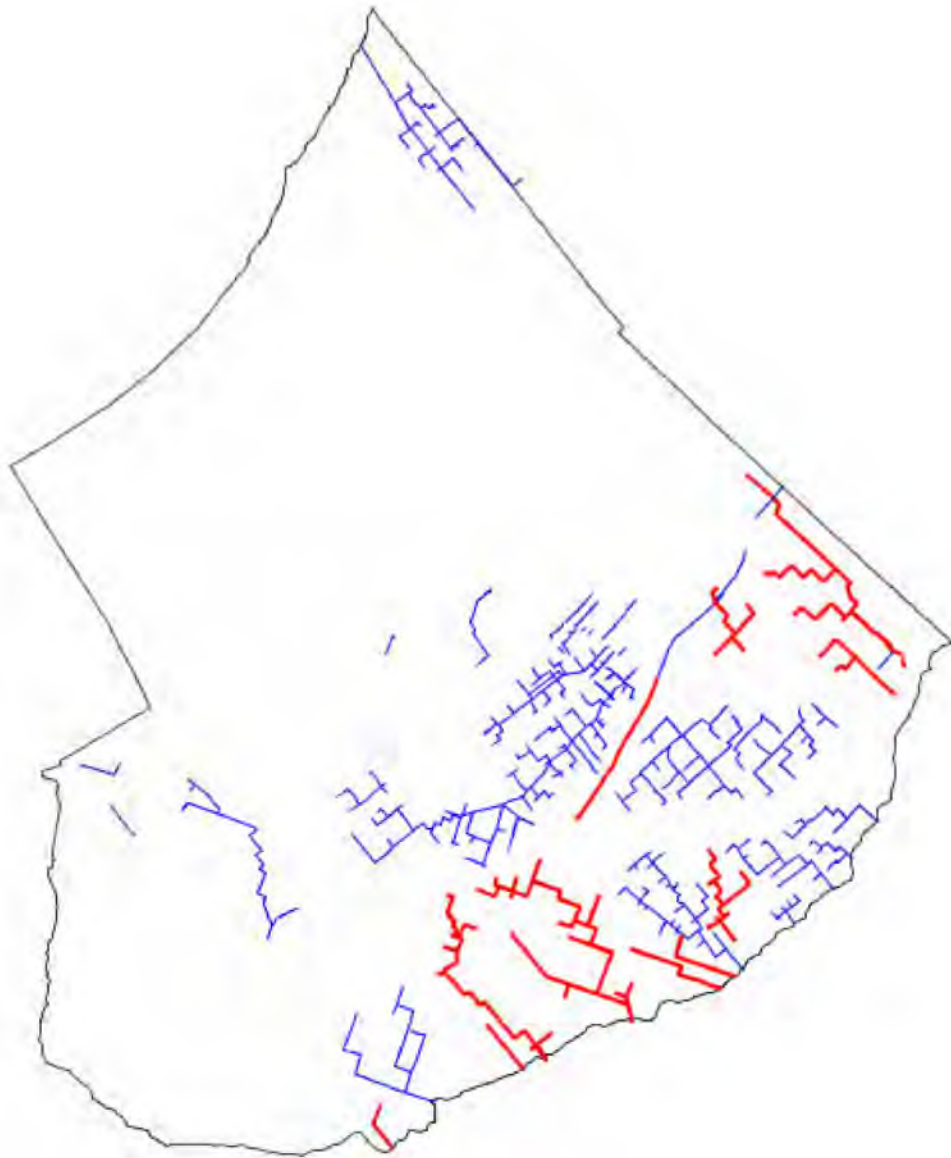
Figura 151: Esquema de distribución de colectores entubados en rojo y colectores a cielo abierto en azul que canalizan el agua de lluvia a libre escurrimiento en zanjas
